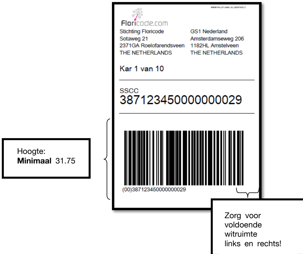
Figuur 5.7: Breedte en hoogte van GS1-128 symbool
